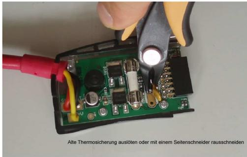
Alte Thermosicherung auslöten oder mit einem Seitenschneider rausschneiden
