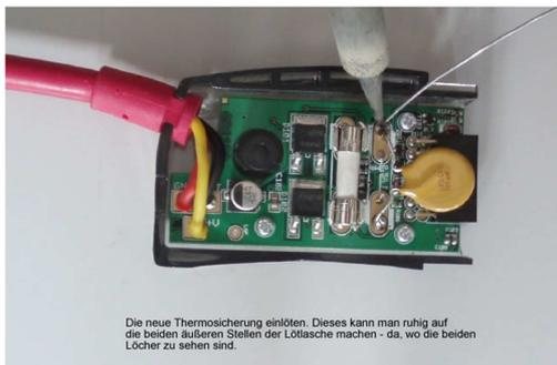
Die neue Thermosicherung einlöten. Dieses kann man ruhig auf die beiden äußeren Stellen der Lötmasche machen - da, wo die beiden Löcher zu sehen sind.
