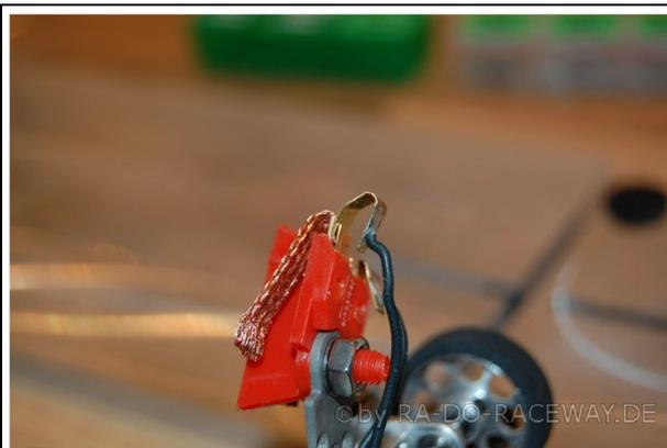
*Schleifer und Kabel-take-up's mit Zange etwas biegen, um eine Vorspannung zu erzeugen.*
