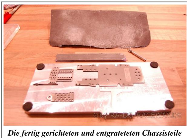
*Die fertig gerichteten und entgrateten Chassisteile*
