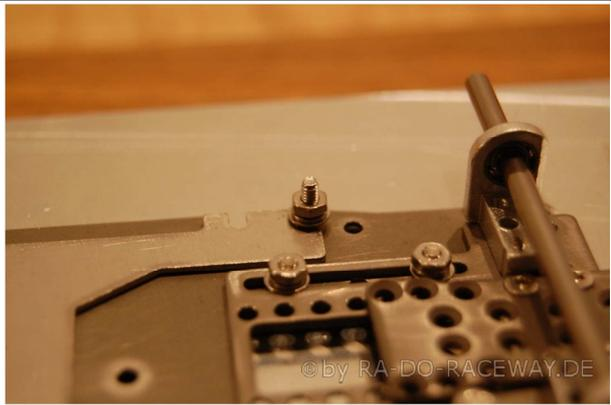
*Dann wird der Träger auf der Grundplatte montiert.*
