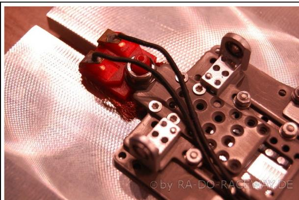
*Hier schon mit montiertem Leitkiel. Es muss unbedingt darauf geachtet werden, dass der Leitkielhalter in dieser abgebildeten Position montiert wird! (auf oberen und unterem Bild ist er falsch montiert)...andernfalls schleift der Leitkiel an der Karosserie.*
