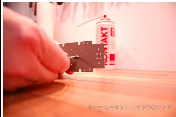
*und alle Löcher der Blechteile mit einem Bohrer oder rSenker von beiden Seiten entgraten.*
