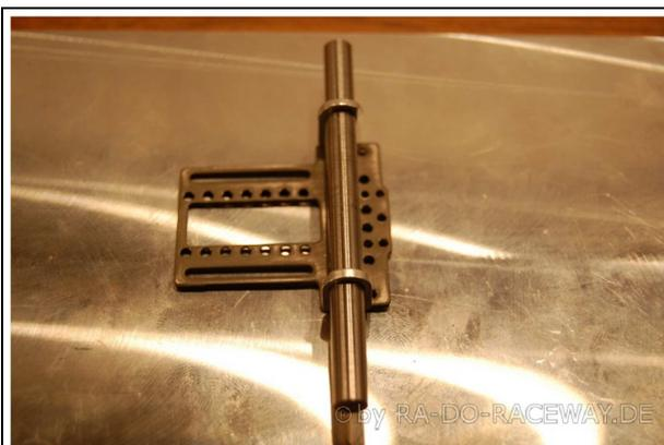
*Montage der Achsböcke mit Hilfe eines Richtwerkzeugs*
