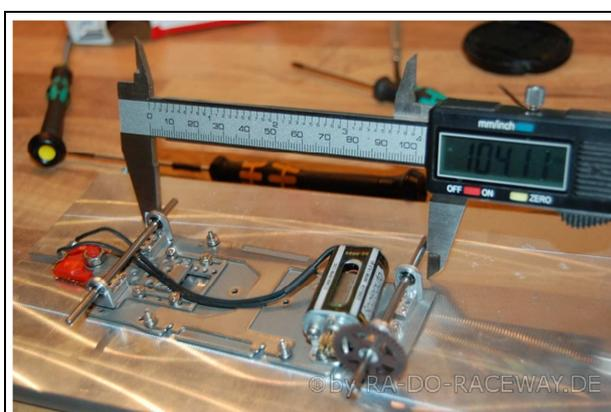
*Die Radstandvermessung sollte so genau, wie möglich geschehen.*
